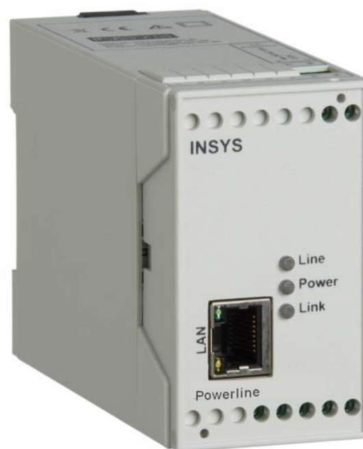
Bild: Macht Stromleitungen zu Datenkabeln – das INSYS Powerline 1.0
