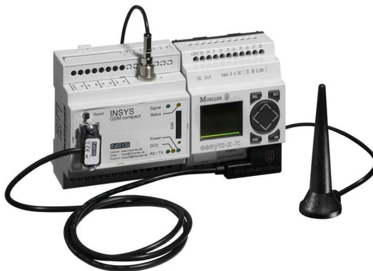
Bild 1: Kostengünstige, drahtlose Fernwartungslösung: INSYS GSM compact mit Moeller-Kleinsteuerung aus der easy-Reihe
